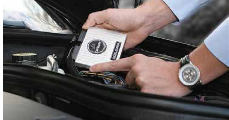
Einbau eines Zusatzsteuergerätes zur Leistungssteigerung
