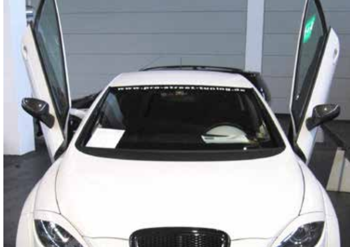
Beispiel für Flügeltürumbau
