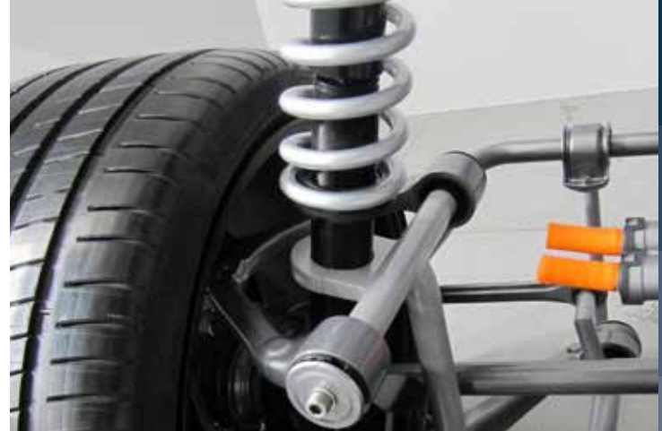
Fahrwerk = Radaufhängung + Achse + Bereifung
