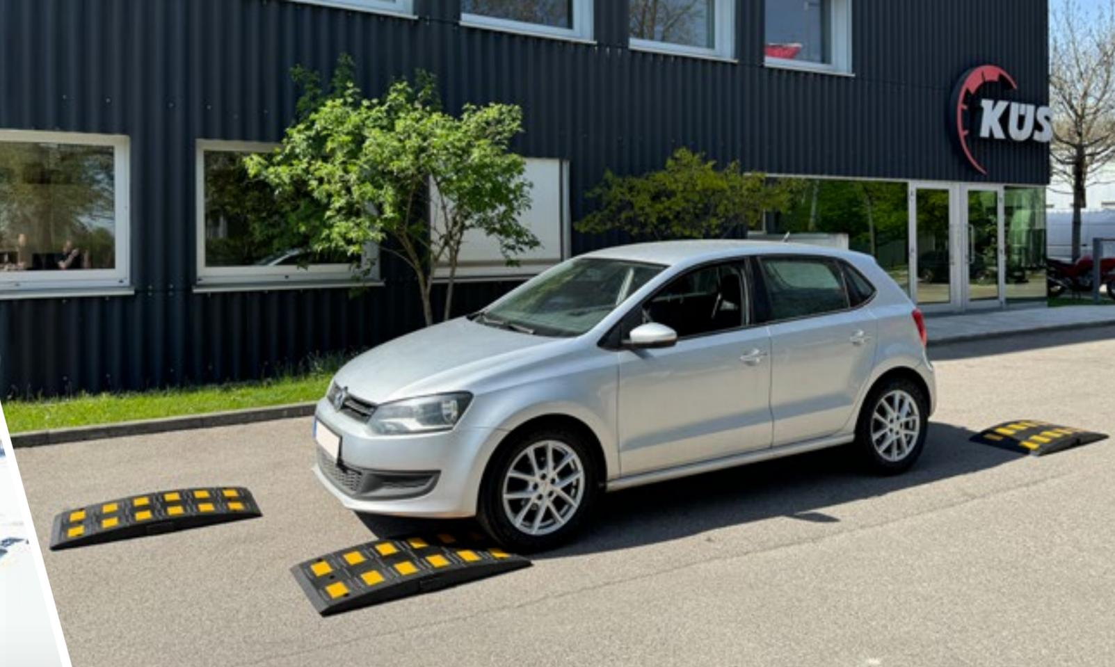
Prüfung der Freigängigkeit der Räder bei Änderungen von Rad-Reifen-Kombinationen und/oder Fahrwerken.
