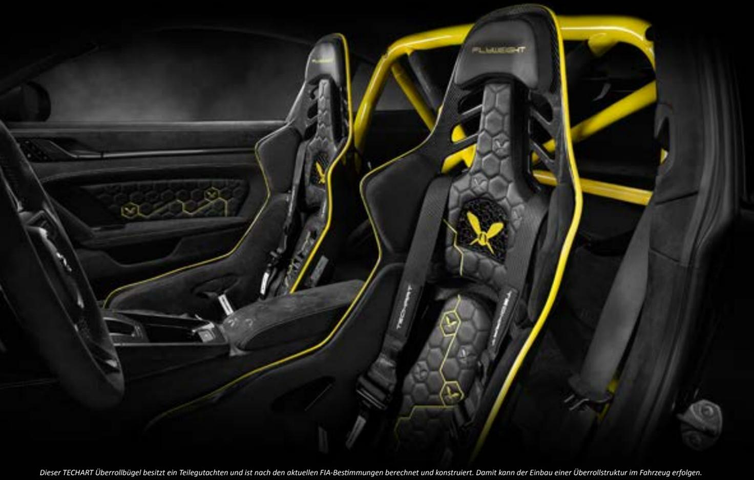
Dieser TECHART Überrollbügel besitzt ein Teilegutachten und ist nach den aktuellen FIA-Bestimmungen berechnet und konstruiert. Damit kann der Einbau einer Überrollstruktur im Fahrzeug erfolgen.
