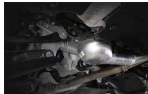
Eine „Warmanbindung“ mit einem Aktor als Teil der Abgasanlage.
