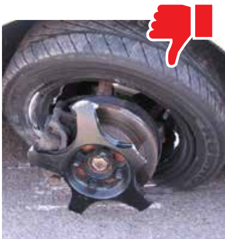
Ergebnis fehlender Festigkeitsprüfungen
