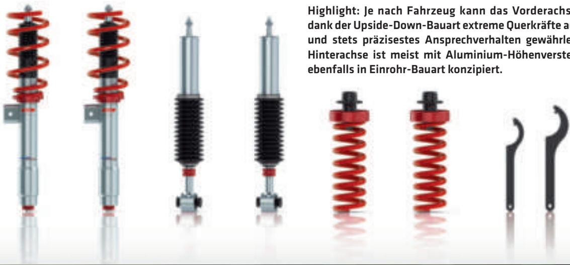
Highlight: Je nach Fahrzeug kann das Vorderachsfederbein dank der Upside-Down-Bauart extreme Querkräfte aufnehmen und stets präzisestes Ansprechverhalten gewährleisten. Die Hinterachse ist meist mit Aluminium-Höhenverstellung und ebenfalls in Einrohr-Bauart konzipiert.
