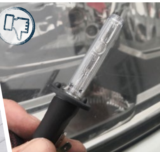
Einsetzen von Xenonleuchten ohne entsprechende Genehmigung
