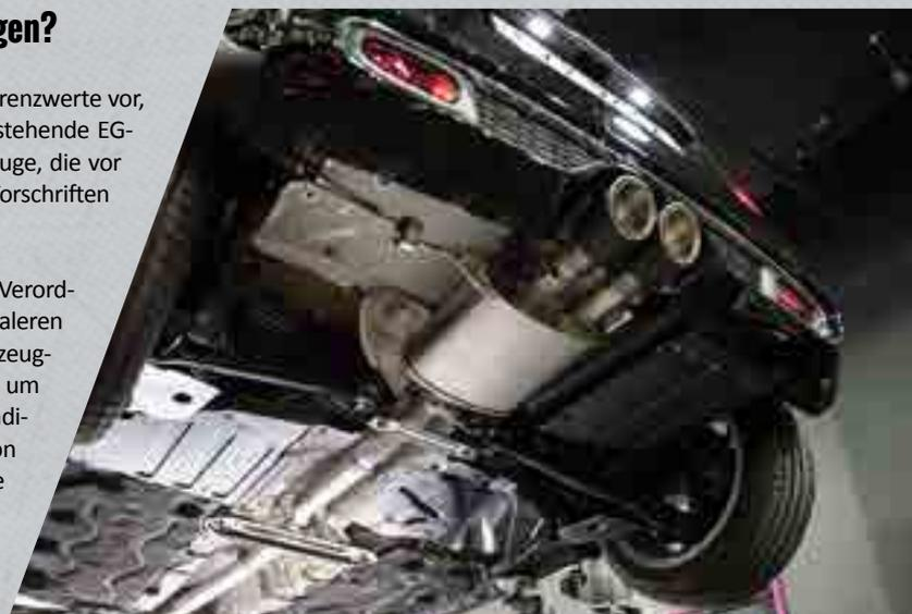
Bild oben links: BMW F22-Q85TR\_HE1: Heckschürzeneinsatz für Fahrzeuge mit M-Paket mit Ausschnitt für 2 x Doppel-Endrohr | Quelle: Bastuck
