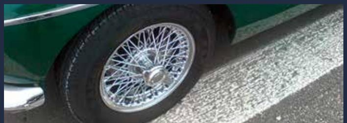
Sollten Spinner, Spinnwheels oder Spinning wheels auf einem Fahrzeug montiert sein und keine Ausnahmegenehmigung vorliegen, ist dies eine Ordnungswidrigkeit. Die Weiterfahrt kann untersagt werden, da eine Gefährdung auf Grund des generellen Verbots dieser Teile begründbar ist.
