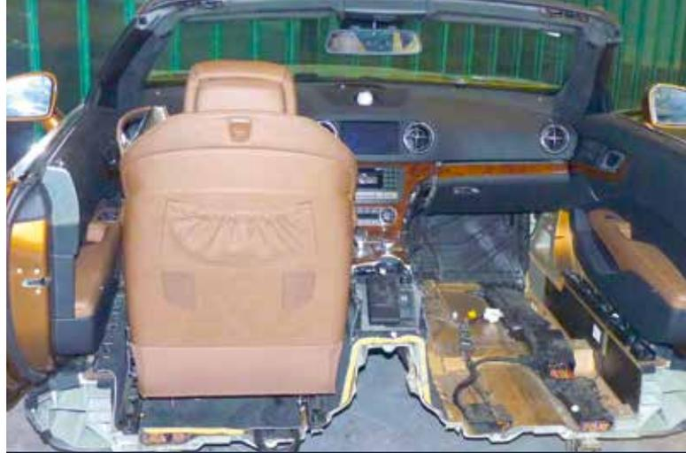
Der Schnitt durch den SLK offenbart spezielle Kabelkanäle, Aluminium-Strangprofile in Längsträgern, Dreifach-Böden, spezielle Formteile – diese Autos können keine Oldtimer werden.
