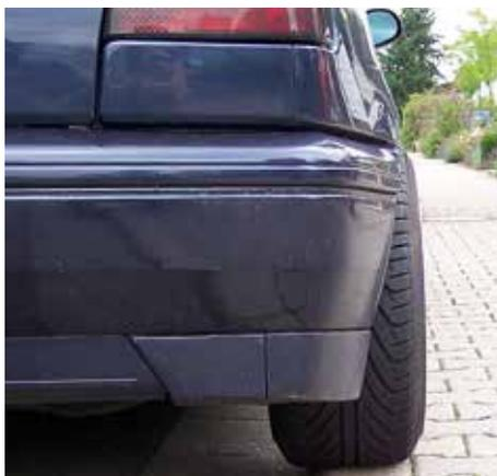
Ausreichende hintere Radabdeckung trotz geänderter Rad-/Reifenkombination.
