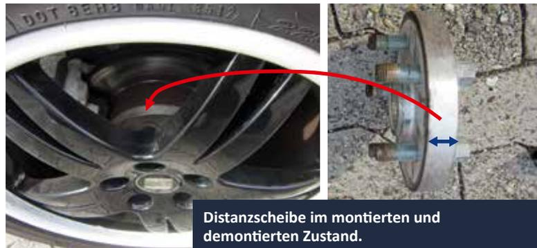
Distanzscheibe im montierten und demontierten Zustand.
