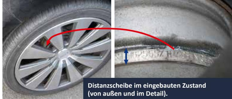
Distanzscheibe im eingebauten Zustand (von außen und im Detail).
