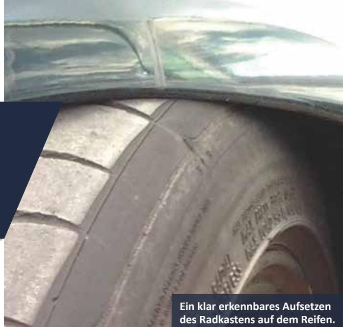
Ein klar erkennbares Aufsetzen des Radkastens auf dem Reifen.
