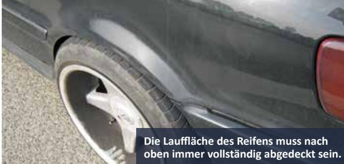
Die Lauffläche des Reifens muss nach oben immer vollständig abgedeckt sein.
