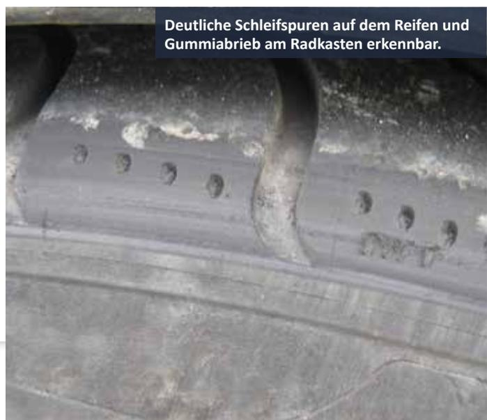
Deutliche Schleifspuren auf dem Reifen und Gummiabrieb am Radkasten erkennbar.
