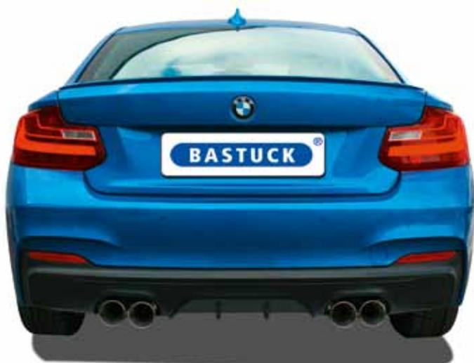
Entwicklung aerodynamischer Fahrzeugaccessoires. Hochwertiges PU-RIM, die exakte Passform und die moderne Sportlichkeit des Heckschürzeneinsatzes garantieren eine deutliche optische Aufwertung. Die Lage und die Form der Endrohre des BASTUCK „Quattro Race“ Endschalldämpfers waren Grundlage für die Modellierung des Heckschürzeneinsatzes, sodass beide Produkte exakt aufeinander abgestimmt sind. Der Heckschürzeneinsatz verfügt über eine Allgemeine Betriebserlaubnis (ABE).
