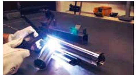
Beim Schweißen der Befestigungspunkte und des Ausgleichsbehälters ist filigrane Handarbeit gefragt.
