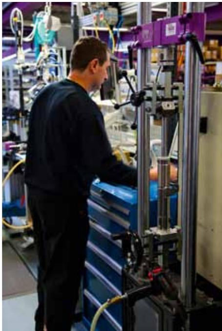
Danach geht es mit dem Dämpfer bestückten Federbein auf die Dämpferprüfmaschine. Bei KW wird jeder einzelne Dämpfer geprüft, um dem hohen KW-Qualitätsanspruch gerecht zu werden.
