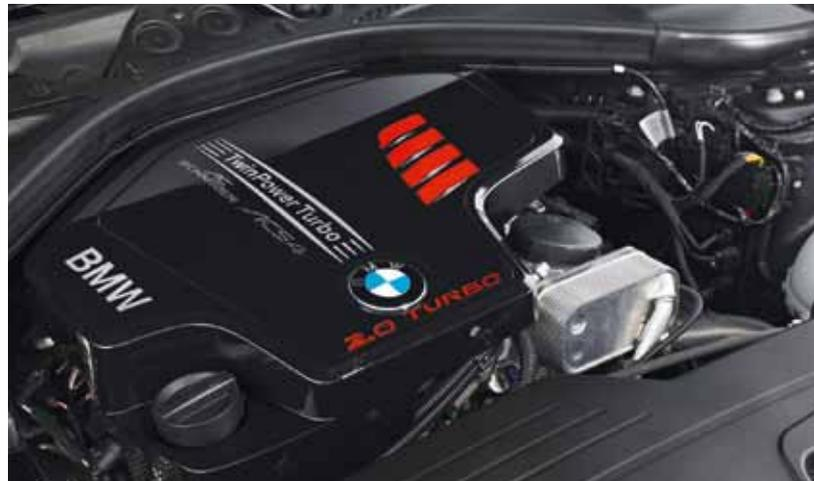
Mit einem Motor-Zusatzsteuergerät erzielte AC Schnitzer eine Leistungssteigerung von 135 kW/184 PS auf 180 kW/245 PS.
