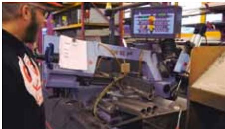
Die auf die fahrzeugspezifischen Längen gekürzten Rohre sind je nach Einsatzzweck aus einer Edelstahl- oder Aluminiumlegierung gefertigt.
