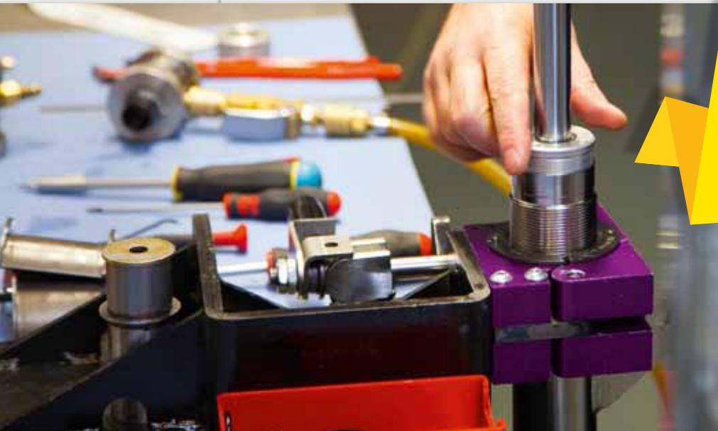
In das Dämpferrohr bzw. Federbein wird das Innenrohr eingesetzt und mit einem speziellen Öl aufgefüllt. Anschließend wird die mit dem Zugstufenventil und dem Kolbenstangendichtungspaket versehene Kolbenstange eingeführt und verschlossen.
