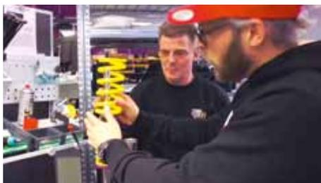
Nachdem Sidney die weiteren Komponenten wie Vorspannfeder, Gewinde- und Zwischenringe, Hauptfeder sowie Anschlagpuffer für sein Gewindefahrwerk kommissioniert hat; kann er das Federbein für den Versand vormontieren. KW Mitarbeiter Martin Klenk gibt ihm noch paar Tipps.
