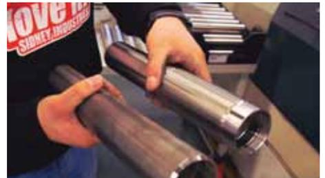
In verschiedenen Arbeitsschritten wird aus dem „Rohr“ das Dämpfergehäuse mit dem Trapezgewinde.
