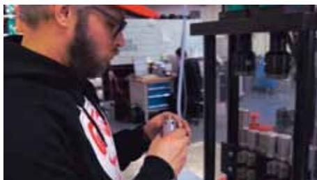
KW Produktmanager Johannes Wacker gibt Sidney ein elektropoliertes Edelstahlgehäuse sowie eine bereits in der Zwischenzeit fertigmontierte Kolbenstange mit integriertem Zugstufenventil und den Rebound-Hülsen für die weiteren Montageschritte.
