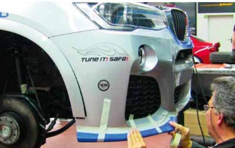
Der BMW X4 2.0i xDrive by AC Schnitzer wurde mit Frontspoiler-Elementen für Fahrzeuge mit M-Technik ausgestattet.
