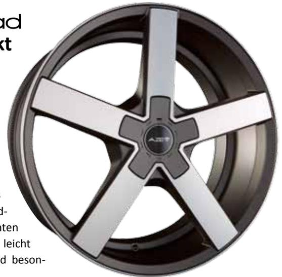
Das Highlight bei dem neuen AZEV-Rad ist ein innenliegendes Felgenbett mit 133 mm Breite. Dieses extrem tiefe, innenliegende Felgenbett in Kombination mit dem leicht konkaven Design der Speichen sorgt für einen optischen Wow-Effekt beim Fahren durch nahezu unsichtbare Speichen. [[www.azev.de](http://www.azev.de)]
