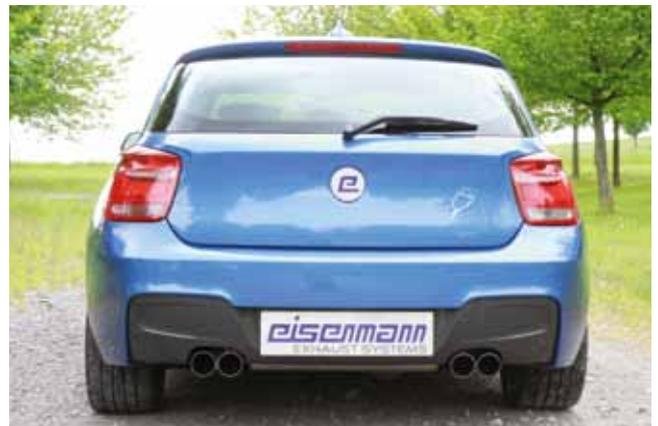
Auf Basis der Entwicklung für den BMW 1er (E87) und den BMW 1er Coupé/Cabrio (E82/E88) hat **Eisenmann** für den BMW 1er F20 M135i eine Sportauspuffanlage entwickelt, die den Klang bis ins Detail verfeinert und die Sportlichkeit spürbar hervorhebt. Den Endschalldämpfer gibt es in zwei Ausführungen: Duplexanlage 2 x 90 mm rund (passend für Serienheckschürze) oder Duplexanlage mit 4 x 76 mm. [www.eisenmann-sportauspuff.de](http://www.eisenmann-sportauspuff.de)
