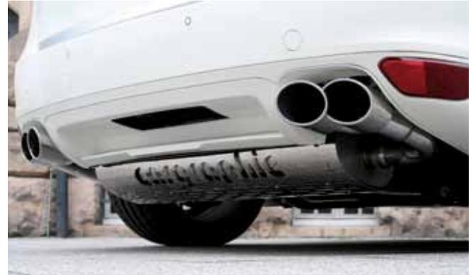
Für den P58 CAYENNE II DIESEL bringt **CARGRAPHIC** eine Auspuffanlage auf den Markt. Diese Anlage umfasst den Sportendtopf V2A komplett mit Anbaumaterial und CARGRAPHIC-Hitzeschild. Alle Sportendtöpfe können mit den OW Endrohren verbaut werden oder optional mit den Endrohren von CARGRAPHIC bestellt werden.
