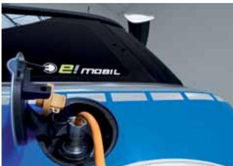
Die Energie für den MINI E kommt aus der Steckdose – unter realen Bedingungen können bei voller Aufladung bis zu 180 km gefahren werden.
