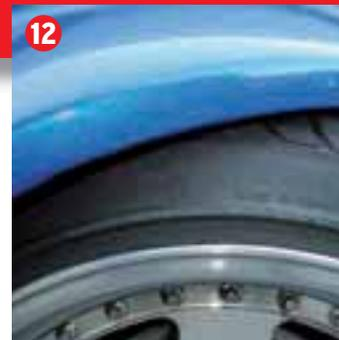
**12.** Zwischen rotierenden und festen Fahrzeugteilen müssen festgelegte Abstände eingehalten werden (zur Bremsanlage 2 mm, zum Fahrwerk 4 mm und zur Karosserie 6 mm). Auch bei maximaler Einfederung darf es zu keiner Berührung kommen.
