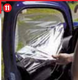
**11.** Diese Seitenscheibe wurde mit Folie beklebt. Dies beeinträchtigt die Sicht (insbesondere bei Dunkelheit) und u. U. das Splitterverhalten des Glases bei einem Unfall.
